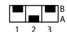
Fig 3B: Tre steg binärt vid fallande temp. Först R1, sedan R2 och sedan R1+R2.
