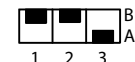
FIG 3A: Trois étages en binaire sur augmentation de la température. D'abord R1, ensuite R2 puis R1+R2.
